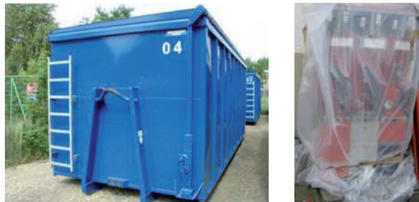
Abbildung 6: Verschließbarer Container Verpacktes Mittelspannungsschaltfeld
