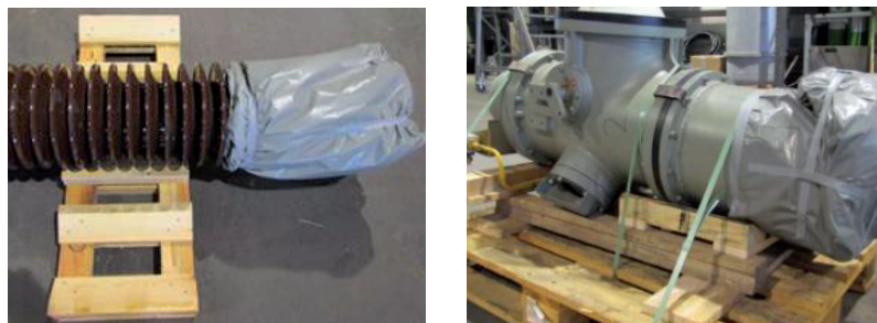
Abbildung 5: Verpackter Erdisolator eines 123-kV-Leistungsschalters / Verpackter Gasraum einer 123-kV-gasisolierten Schaltanlage
